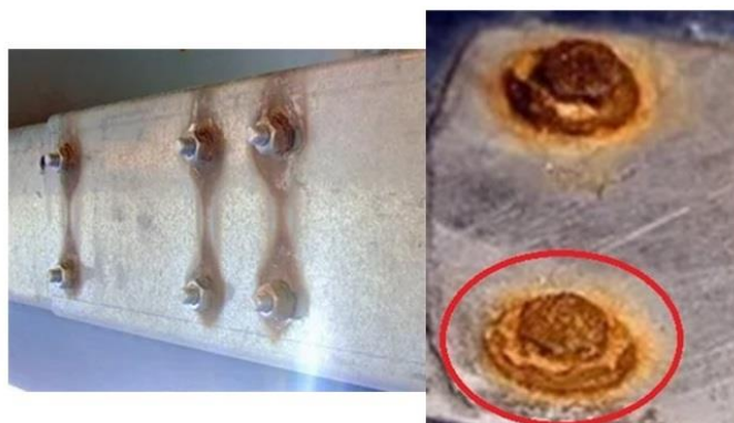
Фиг. 2. Галванична корозия [7]
